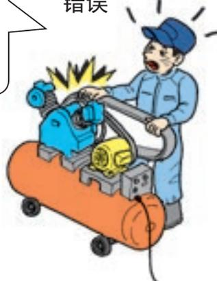
因检查维修而运转停止中切勿触摸开关！
