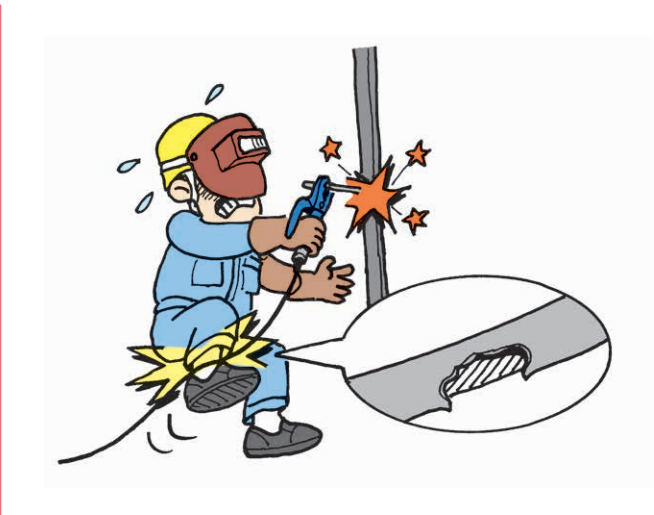
アーク溶接機の2次側配線の露出による感電
