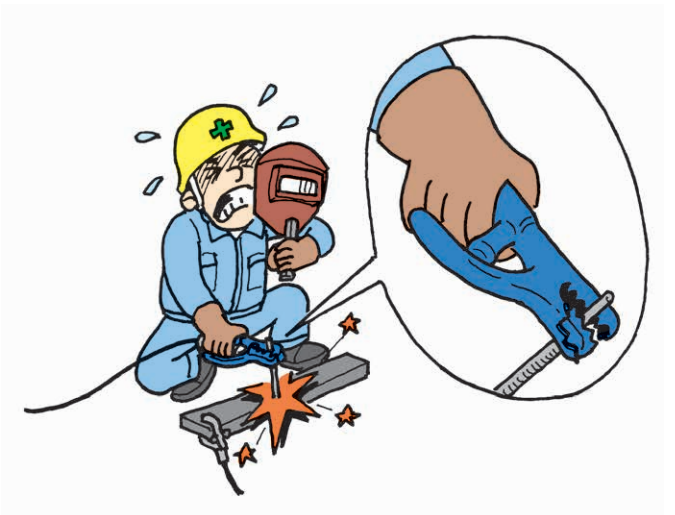
溶接棒ホルダーの焼損による感電 キャプタイヤケーブルの損傷による感電
