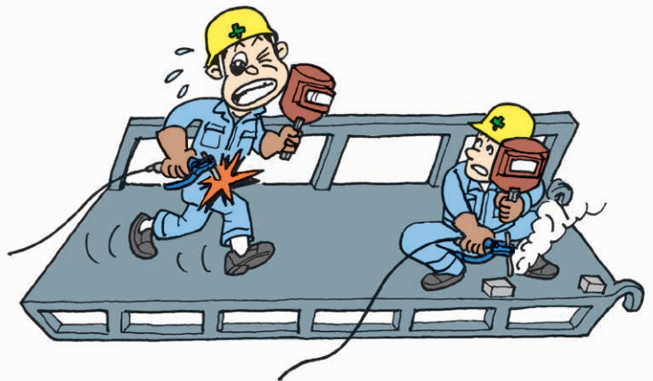
鋼製スロープ製作中に溶接棒が脇腹に接触し感電
