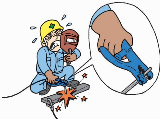
Kesetrum karena terbakarnya pegangan batang dari las
