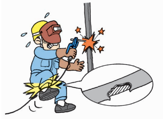
Kesetrum karena terbuka/telanjangnya kable dari mesin las arc
