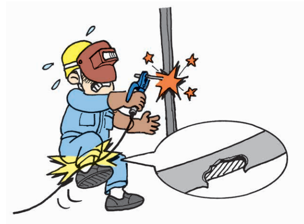
弧焊机的二次侧接线的破损导致触电
