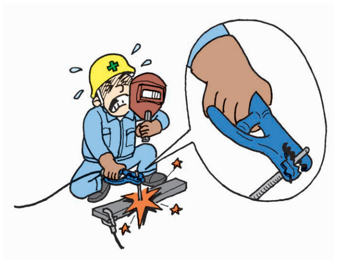
焊条架的烧损导致触电 柔性电缆的损伤导致触电
